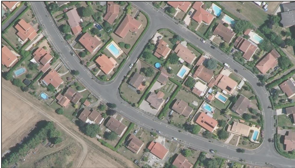
Exemple de voie de lotissements intégrant des places de stationnement le long des voies
